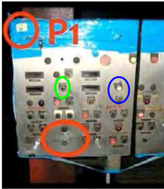
Immagine 43 – Il pulpitino P1 dell'Aspo 1 con il selettore carta.
