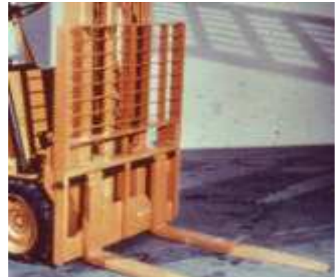
Una ampliación en el respaldo protege al trabajador que la carga se resbale hacia atrás.
